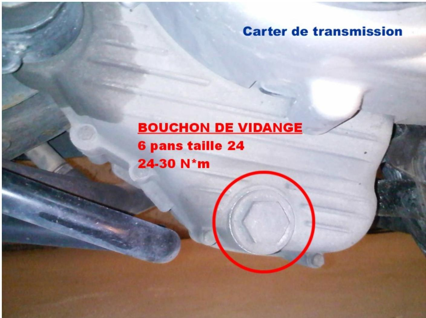
Il y a un joint torique au niveau du pas de vis, essayer de le récupérer au démontage sinon il tombera au fond de l'huile. Par contre on peut le jeter de suite. Vu la pression qu'il a subi (et le prix qu'il coûte), en mettre un neuf au remontage.
