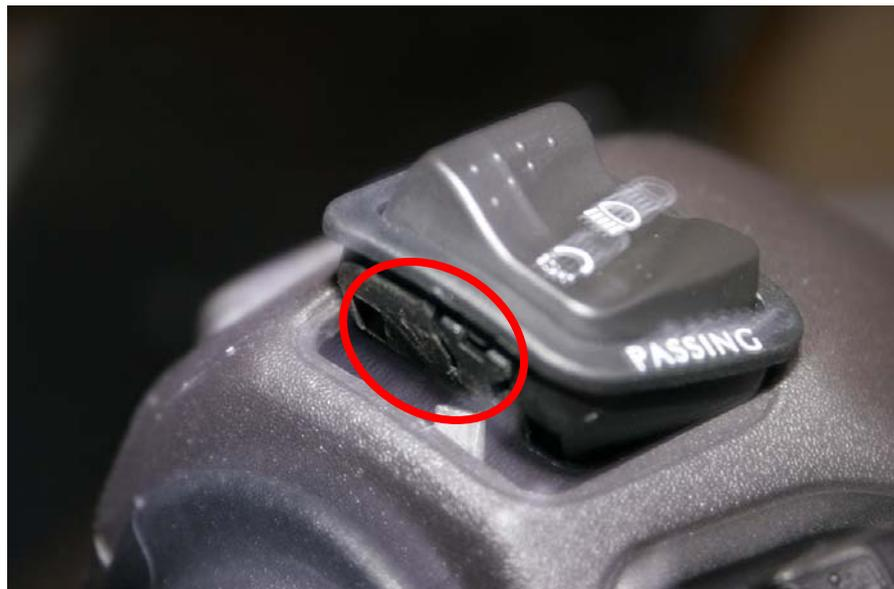
Pont électrique à réaliser ( soudure à l'étain) : entre les 2 fils du milieu.
